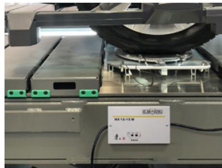
Благодаря встроенному магниту зарядное устройство HS12-15M можно легко установить на любую металлическую поверхность.
